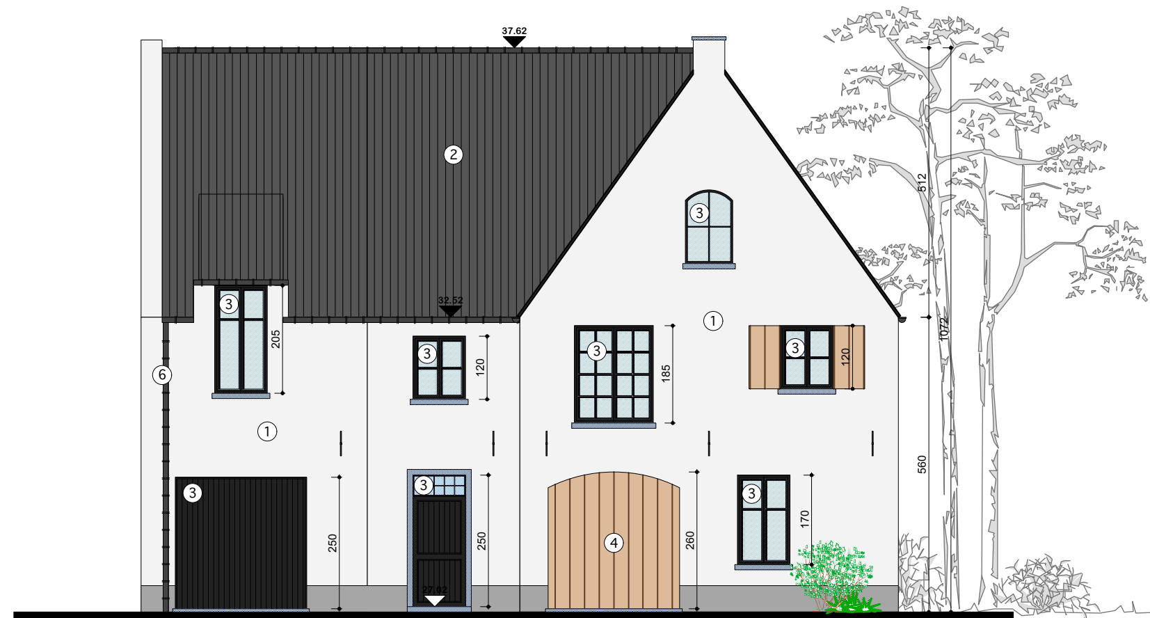
Voorgevel Nieuwe toestand 0 m 1 m 5 m
